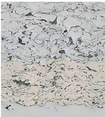
Figura 12a. Micrografía recubrimiento 140MXC-560AS sin ataque químico a100X
