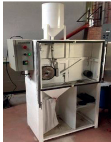
Figura 3b. Equipo de desgaste
