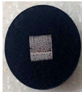
Figura 5b. Detalle de muestra empastillada, sección transversal
